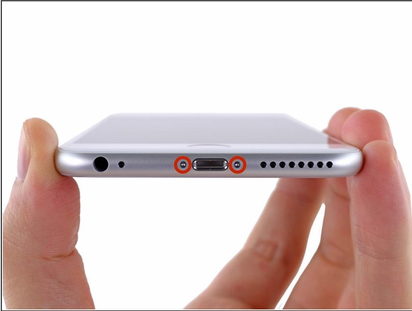
**⚠** Avant de démonter votre iPhone, déchargez la batterie en dessous de 25%. Une batterie lithium ion chargée peut s'enflammer et/ou exploser si elle est percée accidentellement.
