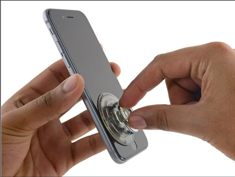
ⓘ Beim Öffnen des Displays des 6s wird ein dünner Klebestreifen durchtrennt, der einmal um das Gehäuse verläuft. Wenn du den Klebestreifen lieber ersetzt, halte jetzt einen Satz neuer Klebestreifen bereit. Es ist möglich, die Reparatur ohne Ersetzen des Klebers zu beenden, und wahrscheinlich merkst du keinen Unterschied in der Funktionalität.
